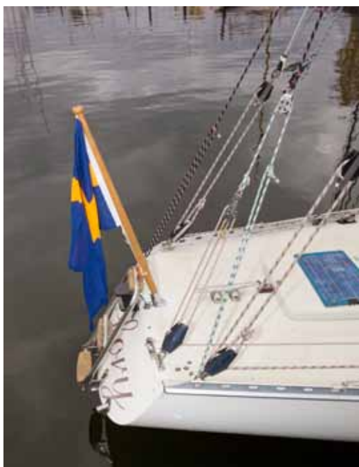
Rejäl utväxling och linor dragna till brunnen gör seglingen aktiv och effektiv.
