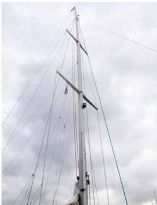
Trimbar rigg. Med både backstag och krumhämmare får man god kontroll över mast och segel.
